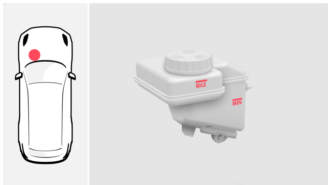
6. Проверьте уровень тормозной жидкости.
