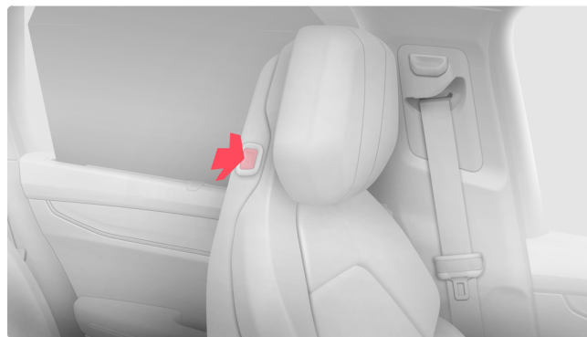
Кнопка фиксатора подголовника переднего сиденья
