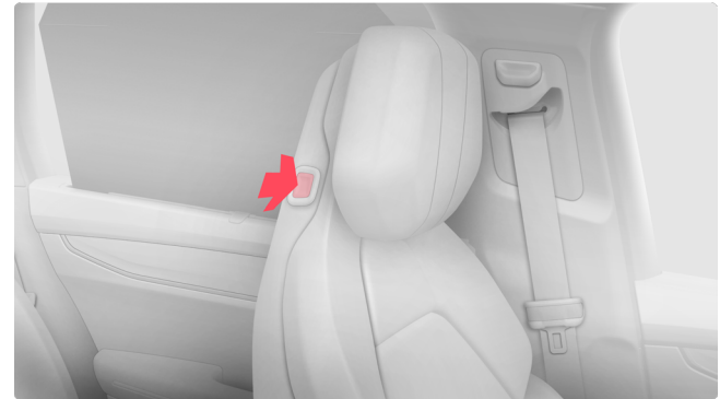
Кнопка фиксатора подголовника переднего сиденья
