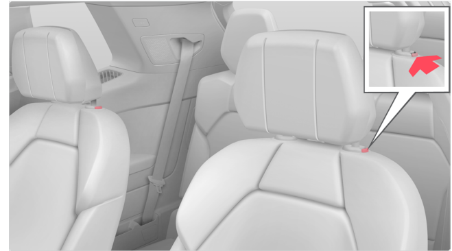
Кнопка фиксатора подголовника сиденья второго ряда
